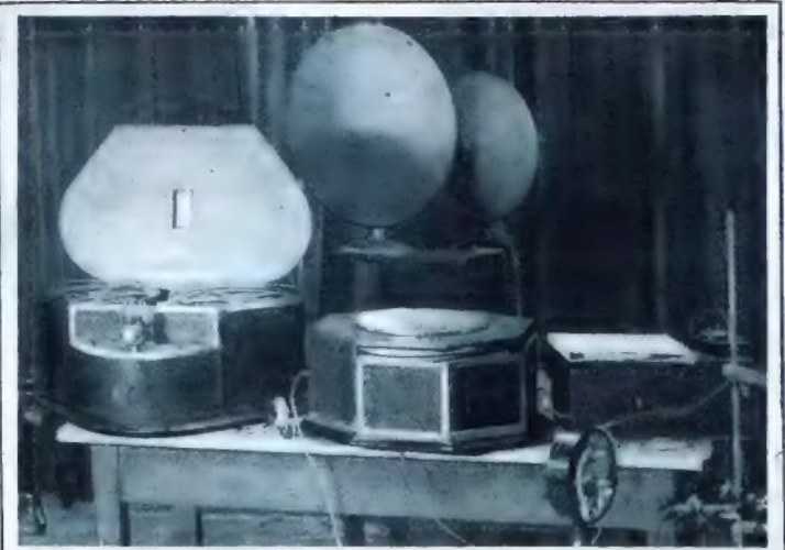
Links die große Type des Selenophon-Junior für Normalfilm. In der Mitte der entsprechende Apparat für Papier-Schmal-Film, rechts der Verstärker.
